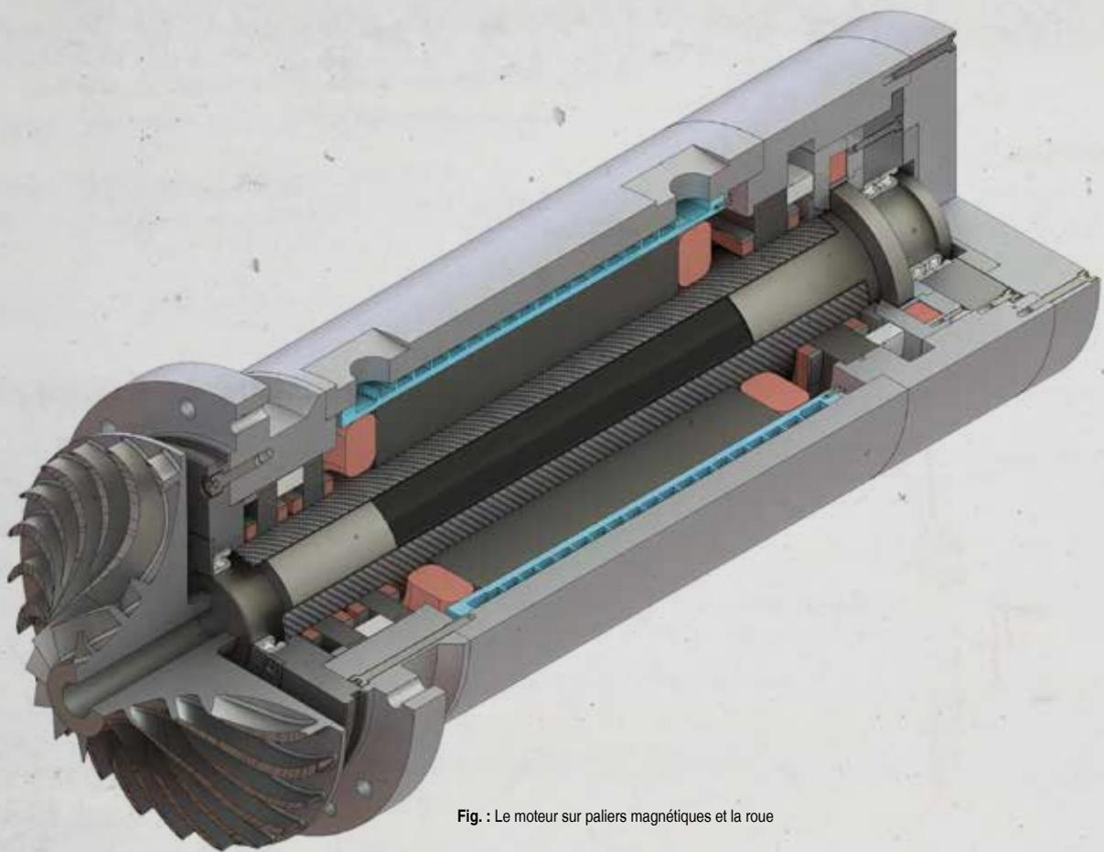
Fig. : Le moteur sur paliers magnétiques et la roue
