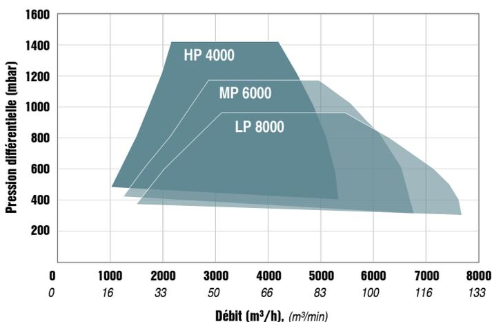
Fig. : Champs de caractéristiques de la série 150 kW
